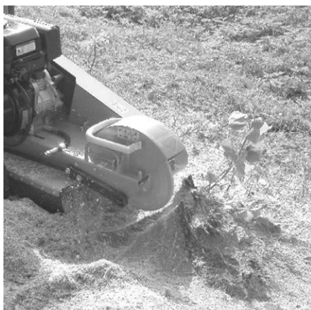
Pakāpeniska smalcināšana no vienas puses
