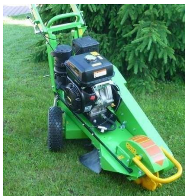
Sāniska griešana uz atbrīvotas pagriežamās pamatnes
